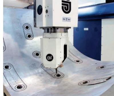
Testa T3D versione Aero per lavorazioni ad alta potenza per il settore aeronautico
