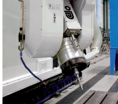
Testa T2D bipolare per lavorazioni di car design & prototyping
