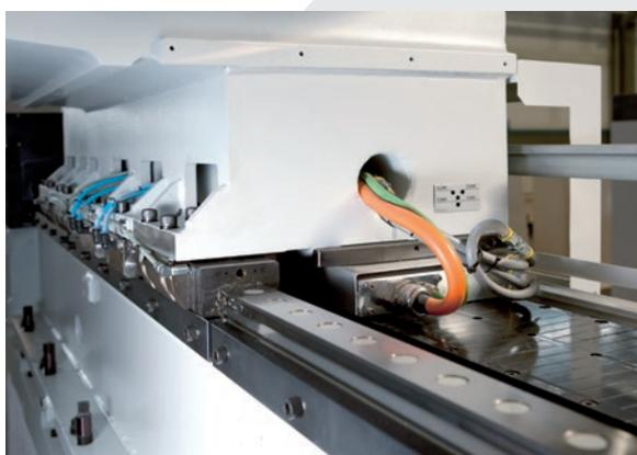
Struttura asse verticale (asse Z) realizzata con canotto che scorre dentro il carro su guide a rulli precaricati ad ampia sezione
