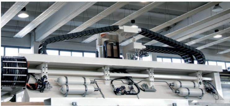
Sistema di bilanciatura idro-pneumatico di grande efficienza per la compensazione masse del gruppo asse Z, realizzato con doppio cilindro diretto
