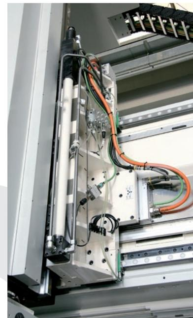
Struttura asse trasversale (asse Y) realizzata con traversa ottimizzata dimensionalmente con guide a rulli precaricati ad ampia sezione per lo scorrimento del carro
