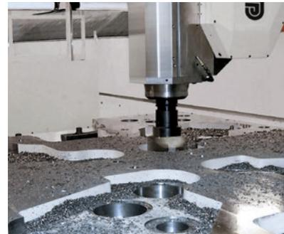
Testa TMX indexata per lavorazioni di meccanica generale di precisione
