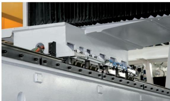
Struttura asse longitudinale (asse X) ampiamente dimensionata su cui sono fissate le guide a ricircolo di rulli precaricati ad ampia sezione installate su colonne
