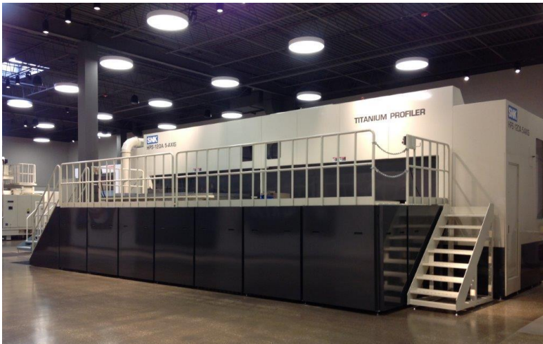
Der 5-Achsen Profiler HPS-120A von SNK für die Titanbearbeitung
